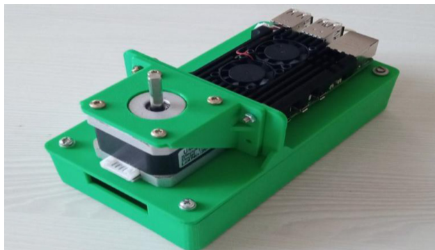
Рис. 1. Прототип корпусу лабораторного стенду для опанування основ комп'ютерного зору на базі одноплатного комп'ютера Raspberry Pi 5
